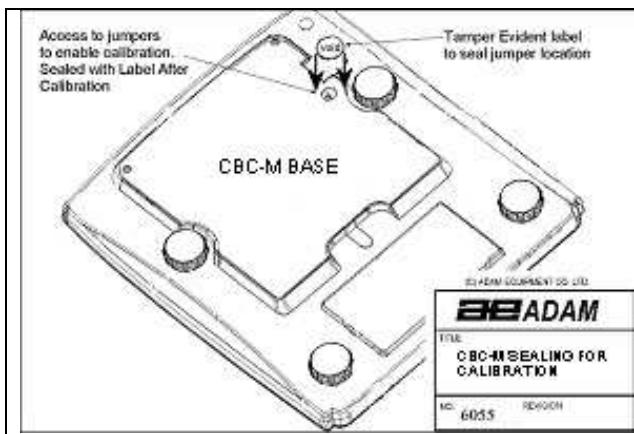
Um die Kalibrierung der CBC-M-Waagen durchzuführen, entfernen Sie die Siegelmarke auf dem Unterteil der Waage über der Öffnung, durch die Sie Zugang zur Leiterplatte haben. Ist diese Öffnung versiegelt, müssen Sie die Plomierung aufbrechen und den Schutzdeckel entfernen, um innen an die Leiterplatte zu gelangen. Siehe untere Skizze (Sicherungssiegel)
