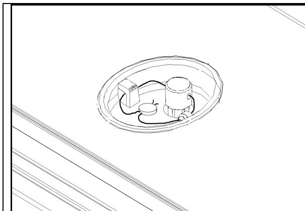
Zur Versiegelung der Waage kann eine Metallplombe benutzt werden, wie links gezeigt. Im Unterteil der Waage ist ein Stift aus Metall, der aus der Schutzabdeckung hervorragt. Die Plombe kann durch diesen Stift eingefädelt werden. Das Entfernen der Abdeckung ohne die Plombe oder das Gehäuse zu verletzen ist dann unmöglich.
