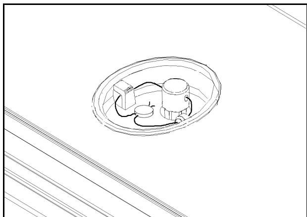
Pour sceller la balance un câble plombé peut être utilisé comme montrée ci-contre. La base possède une goupille en métal qui sort à travers du boîtier. Le plomb de sécurité peut être fixé à travers sa goupille en métal, rendant impossible l'extraction du couvercle sans endommager le plomb de sécurité ou le boîtier.
