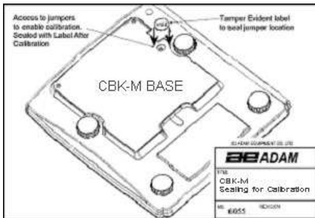
Le calibrage de la balance CBK-M est accompli en retirant l'étiquette de la base de la balance laquelle couvre un trou à travers lequel le circuit interne PCB peut être atteint. Si votre balance n'est pas fournie avec ce trou, vous devez alors casser le plomb de sécurité et enlever la partie haute du boîtier pour accéder au circuit interne. Voir l'illustration sur le plomb de sécurité ci-dessous.
