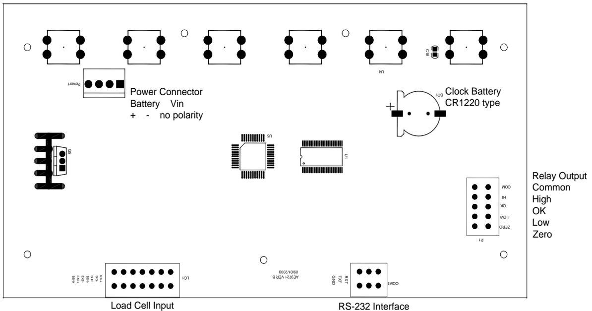
El circuito de control de los relés requiere una voltaje externo compatible con los relés utilizados. Para obtener más información, véase la sección 10.
