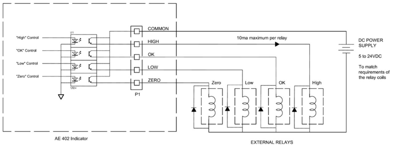
Las conexiones se realizan a la PCB, conector P1. El conector es un tipo activado por resorte, simplemente pulse la parte superior del conector e inserte el cable.
